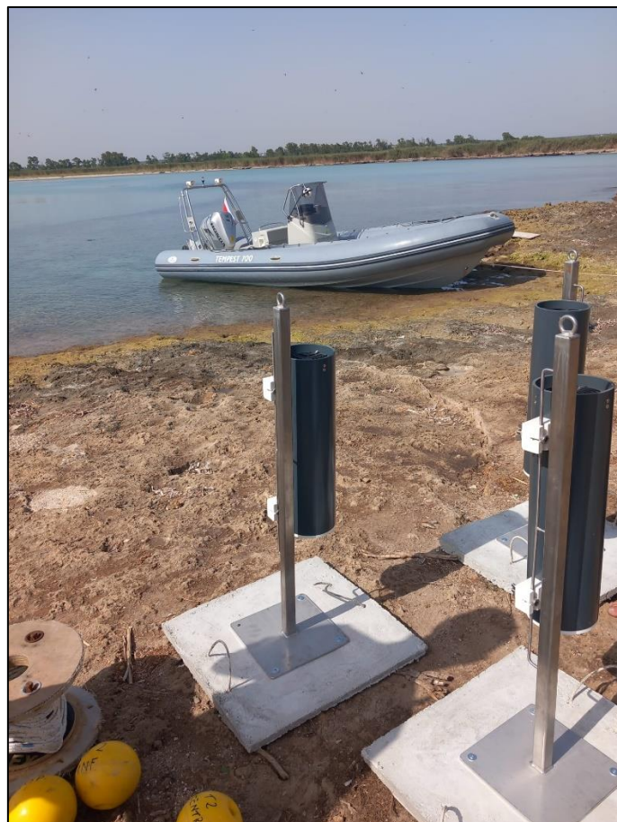
Figura 10 – Trappole sedimentarie prima dell'installazione
